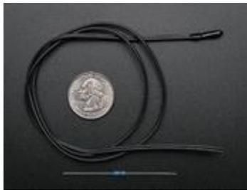
*Figure 16: NTC-Thermistor*
