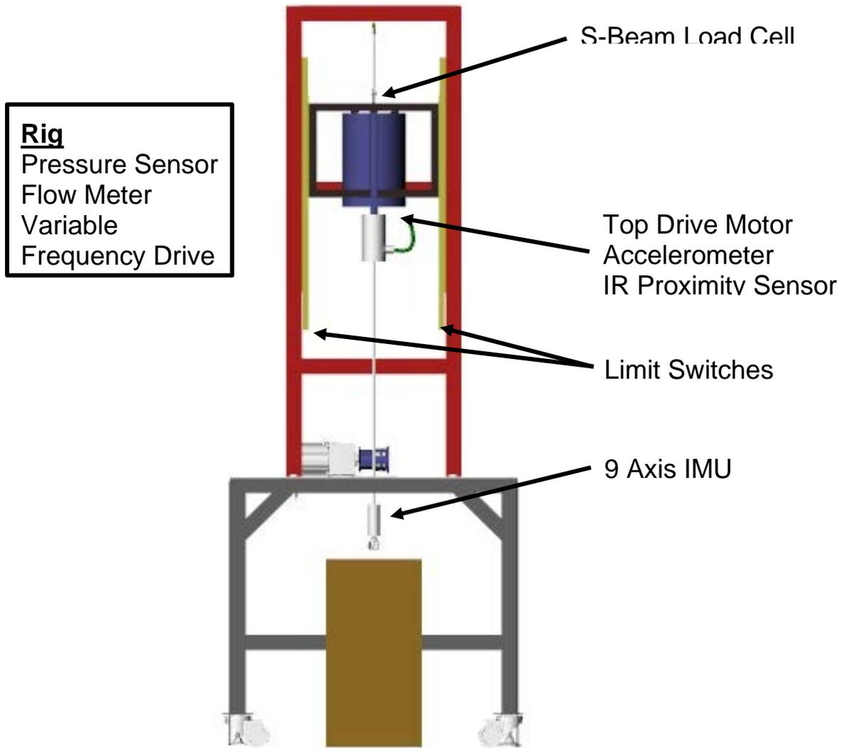
*Fig. 19: Sensor Placements*
